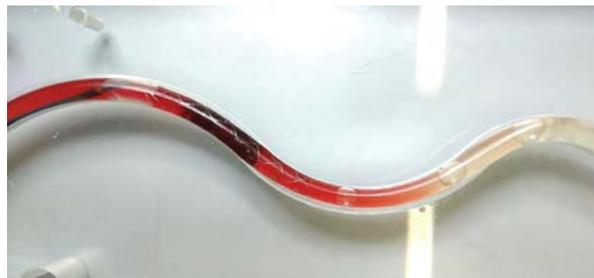
Рис. 7. Раскрытие сетки стент-ретривера в тромбе
