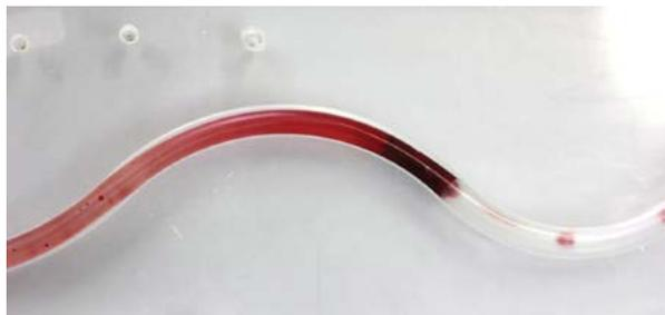
Рис. 6. Тромб в испытательном стенде
